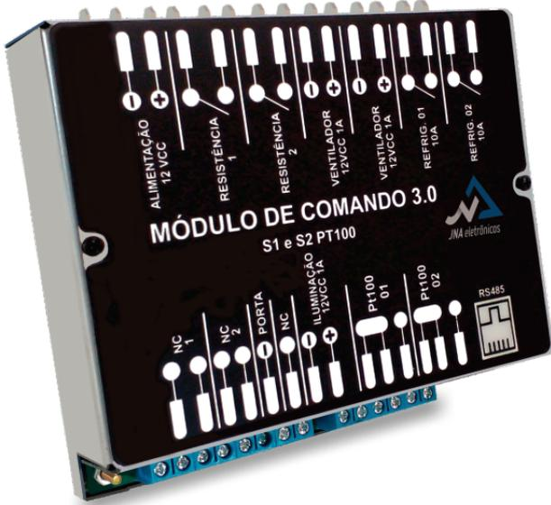
O Módulo de Comando é um dispositivo que possui capacidade de ler 2 sensores (PT100 ou NTC), através de 4 saídas de relés oferecer controle sobre sistemas de refrigeração, aquecimento, ventilador e iluminação.
